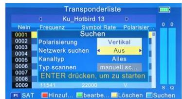
Netzwerk suchen: Ein (Komplette Transponderliste des Satelliten wird durchsucht); Aus (Nur die im Messgerät hinterlegten Transponder werden durchsucht)
