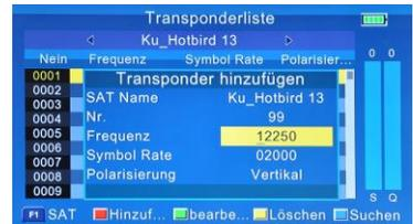
Die Werte eines bestehenden Transponders können mit einem Druck auf die grüne Taste geändert werden.
