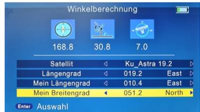
Oberhalb der Eingabe werden Ihnen nach erfolgter Eingabe die berechneten Werte für Azimut, Elevation und Skew (LNB Kippwinkel) angezeigt. (von links nach rechts)
