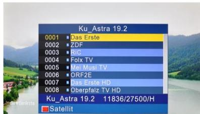
Mit der roten Taste öffnen Sie die Auswahlliste mit der Sie zwischen den Satellitenlisten bzw. DVB-T (Germany) und DVB-C (Germany\_DVBC) Listen wechseln können. Wählen Sie dazu mit **▲▼** den gewünschten Eintrag und klicken Sie auf **OK**.
