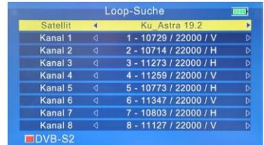
Treffen Sie anschließend Ihre Auswahl an Transpondern / Kanälen mit **◀ ▶**. Sind alle Angaben korrekt, starten Sie die Loop-Suche mit einem Druck auf die **OK** Taste.
