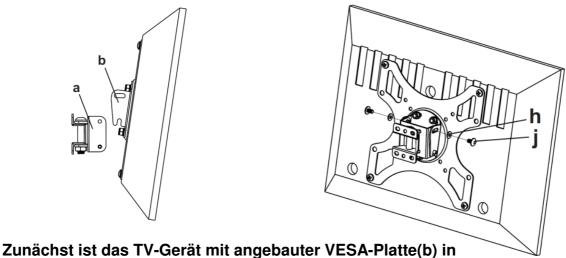
die montierte Wandplatte(a) einzuhängen. Sodann erfolgt die abschliessende Befestigung mit den Schrauben(j) und den Unterlegscheiben(h).
